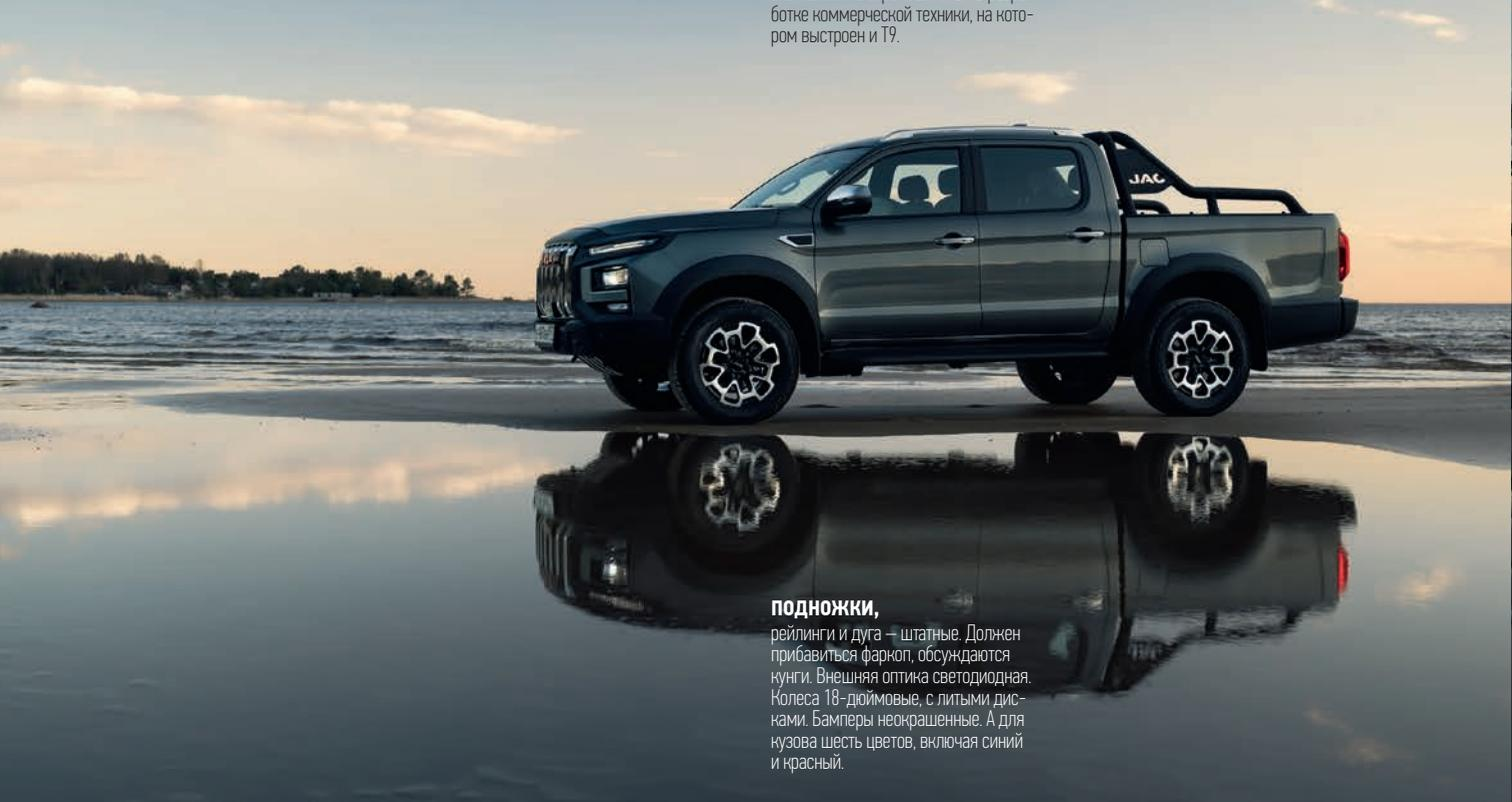
**ПОДНОЖКИ,** рейлинги и дуга – штатные. Должен прибавиться фаркоп, обсуждаются кунги. Внешняя оптика светодиодная. Колеса 18-дюймовые, с литыми дисками. Бамперы неокрашенные. А для кузова шесть цветов, включая синий и красный.
